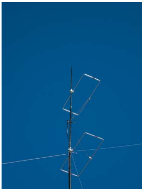
Tester gjordes också med 2 stackade Moxon- antennerna för 2 m, även dessa resta med hjälp av Spiderbeam-mast.
