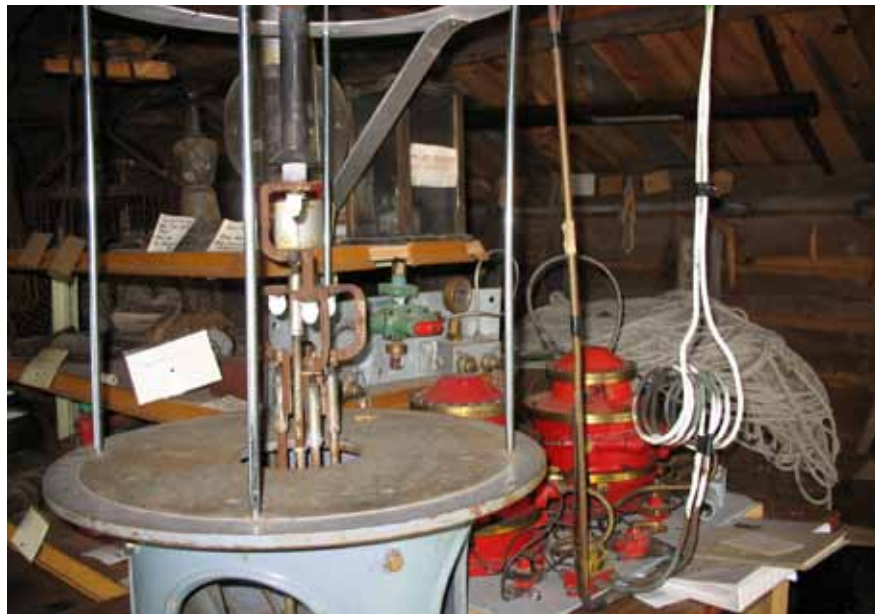
Glödnätsutbytare med klippapparat och Dalénblandare från Sandö fyr i Gryts Hembygdsförening.
